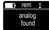
Wird ein gültiges Signal empfangen, erscheint über der Mengenanzeige ein kleines „R“. Wird das Poti auf der Fernbedienung über 10% gedreht und der Schalter ist eingeschaltet, wird der Nebelvorgang gestartet. Der Ausstoß kann nun in den Stufen 25%, 50%, 75% und 100% eingestellt werden.
