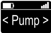
Hierbei ist noch kein Menüpunkt angewählt. Durch das Menü kann nun mit der Minus/Links (9) und der Plus/Rechts (10) Taste geschaltet werden. Die Menüabfolge ist *Pump* → *Mode* → *Info*.
