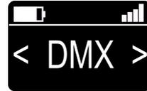
Nun kann mithilfe der Minus-Taste (9) und Plus-Taste (10) die DMX-Adresse verändert werden. Die Adresse wird nach zwei Sekunden automatisch übernommen. Dies wird mit einem Blinken der Adresse angezeigt.
